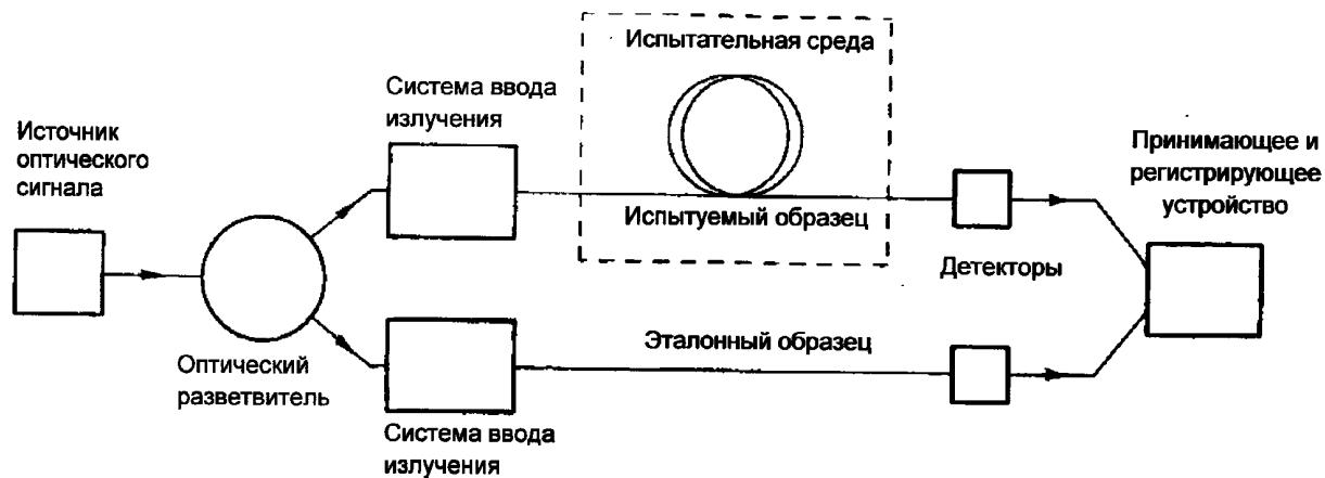
Рисунок А.1 – Измерение изменения коэффициента оптического пропускания
