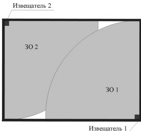
Рисунок 5.10 – Блокировка помещений, размеры которых превышают максимальную рабочую дальность действия извещателя (2 извещателя)
