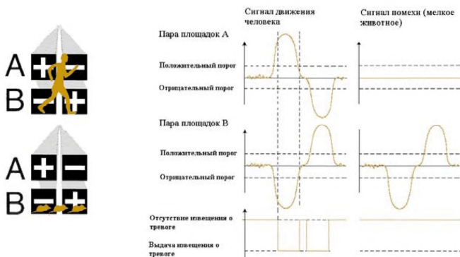
Рисунок 3.6 – Увеличение помехозащищенности извещателя при применении четырехплощадного тироприемника
