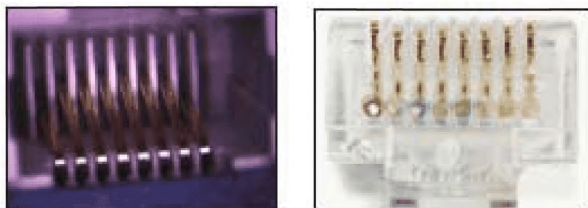
Рисунок 4: Слева показано гнездо RJ45, поврежденное недостаточно обжатой вилкой RJ45. Внешние ламели продавлены и постоянно находятся ниже остальных ламелей. Справа показана вилка RJ45, контакты которой обжаты неравномерно и могут вызывать такие повреждения.
