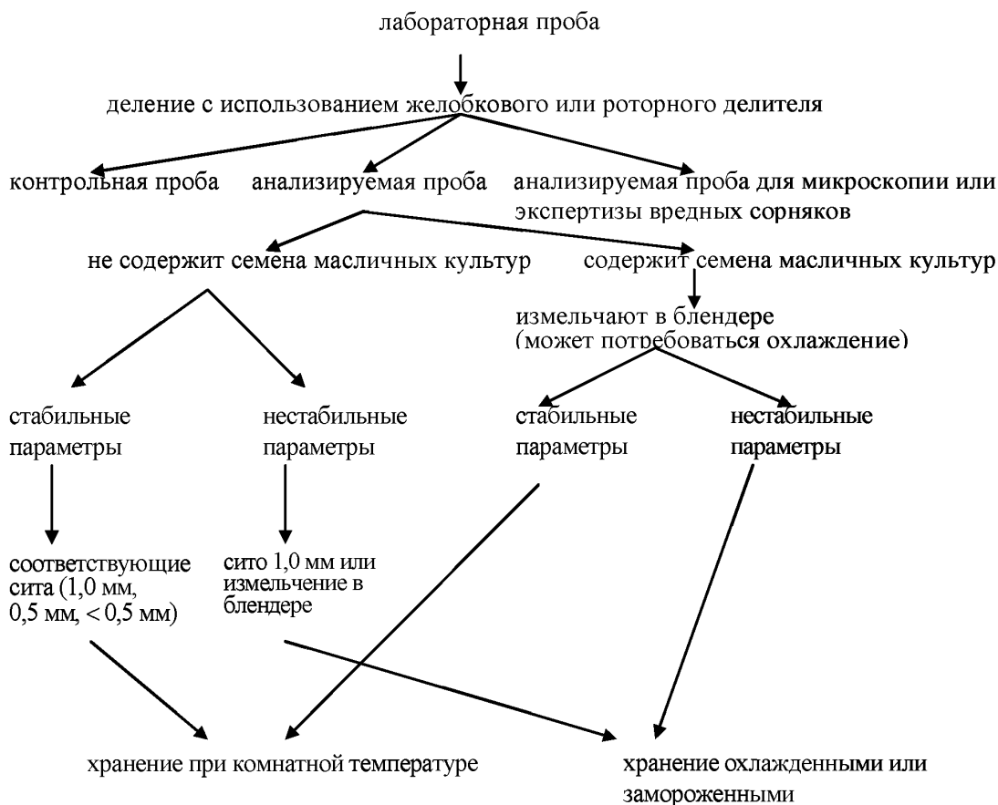
Рисунок 4 — Схема подготовки проб корма для птиц
