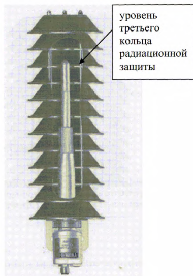
Рисунок 8.4 – Правильное расположение датчика температуры и влажности внутри радиационной защиты
