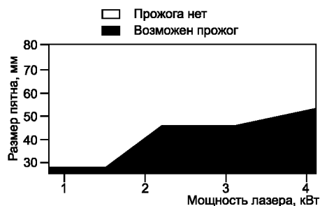
Рисунок F.21 — Стойкость к разрушению листа нержавеющей стали толщиной 1 мм от 10 с экспозиции расфокусированного пучка во время экспериментов с использованием непрерывного лазера на иттрий-алюминиевом гранате с неодимом
