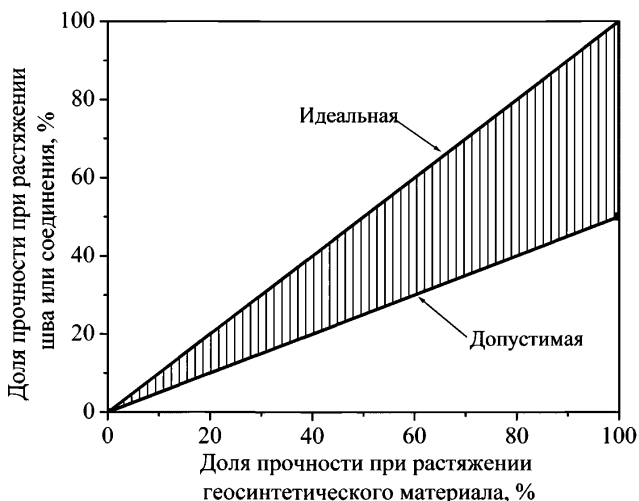
Рисунок 8.1 – Зависимость между прочностью геосинтетического материала и прочностью шва или соединения
