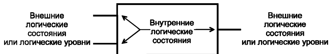
Рисунок 38 — Иллюстрация терминов «состояния» и «уровни»
