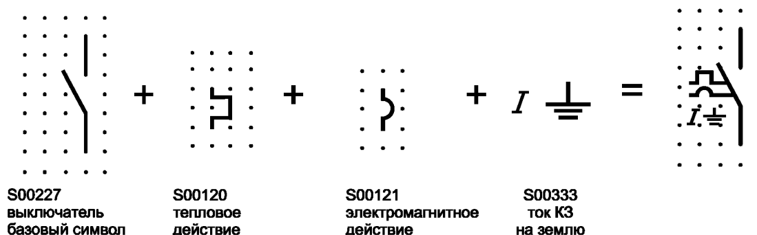
Рисунок А.7 — Символическое представление автоматического микровыключателя с устройством остаточного тока, вариант 1
