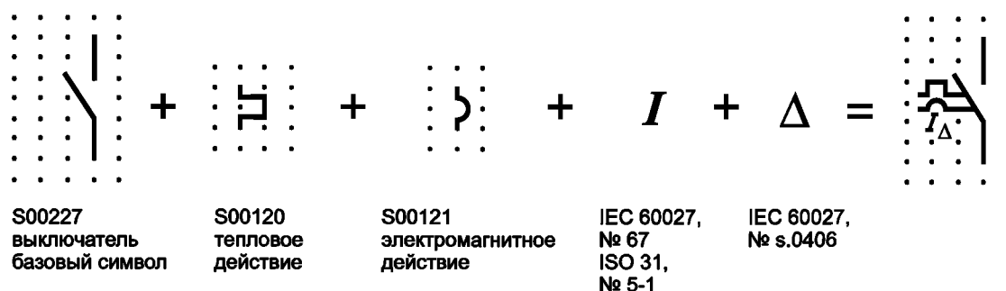
Рисунок А.9 — Символическое представление автоматического микровыключателя с устройством остаточного тока, вариант 3
