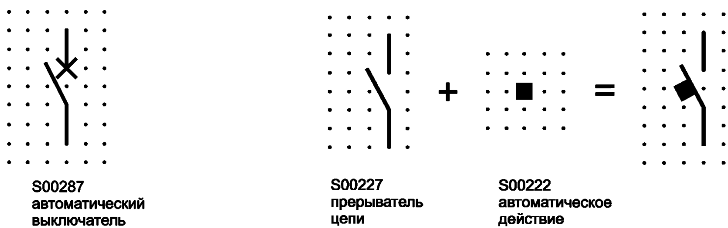
Рисунок А.2 — Микровыключатель, показанный с помощью символа автоматического выключателя
