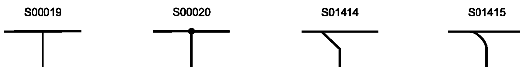
Рисунок 27 — Символы, представляющие сочленение соединительных линий
