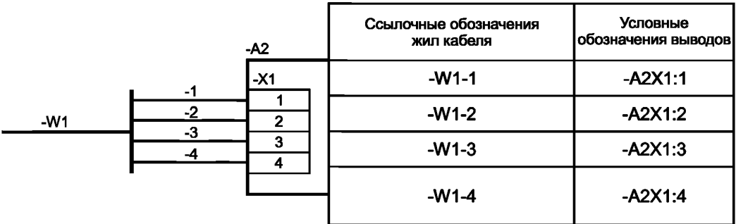
Рисунок 79 — Пример представления концевой заделки многожильного кабеля
