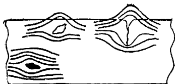
Рис. 2.21. Расположение магнитных силовых линий в зоне дефектов
