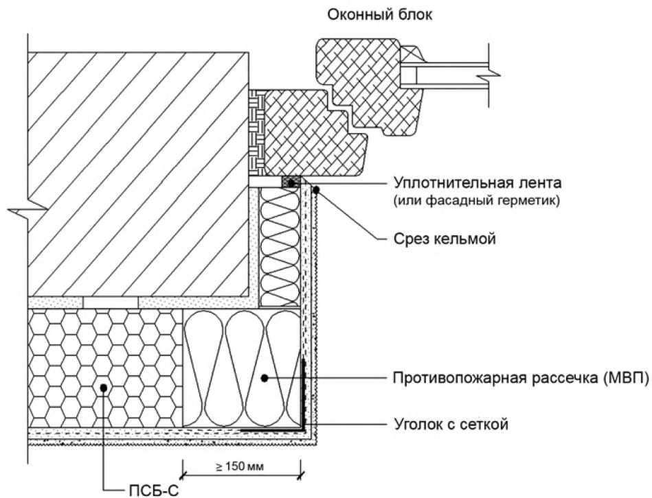
Рис. 6. Утеплитель и окантовки боковых откосов проемов
