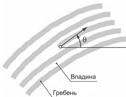
Рисунок 4 — Расположение контрольной точки окончания остова гребня
