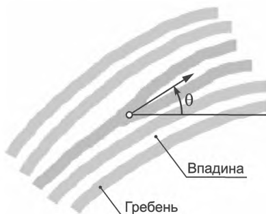
Рисунок 3 — Расположение и направление контрольной точки бифуркации гребня (закодированной в качестве точки бифуркации остова гребня)
