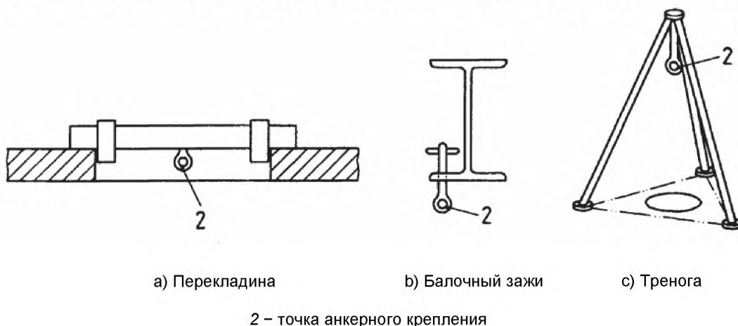
Рисунок 3 – Класс В. Примеры переносных временных анкерных устройств
