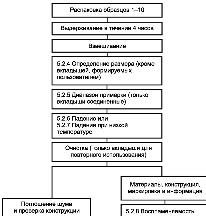
Рисунок В.3 — Блок-схема испытания вкладышей
