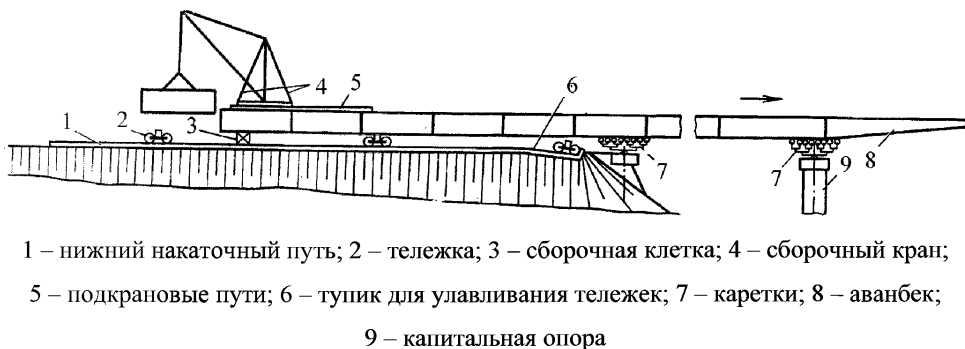
Рисунок 6.6 – Схема надвигки пролетного строения с применением тележек и кареток
