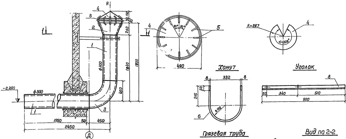
Спецификация материалов на переливную и грязевую трубы
