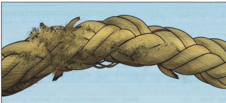
Рисунок С.11 – Механические повреждения
