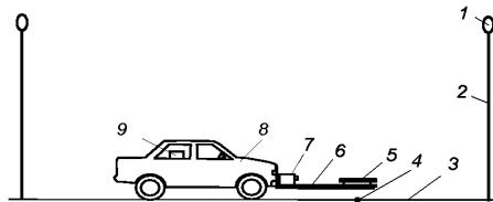
1 — светильник; 2 — опора; 3 — покрытие контрольного участка; 4 — точка измерения; 5 — тест-образец покрытия;
