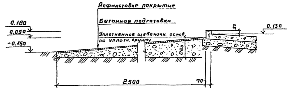
Деталь отмостки по буквенным осям.
