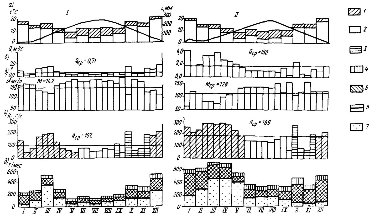
Рис.5. Годовой ход температуры воздуха,  $^\circ\text{C}$ ; атмосферных осадков и испарения, мм (а); расхода,  $\text{м}^3/\text{s}$  (б); минерализации,  $\text{мг/л}$  (в); ионного стока,  $\text{г/с}$  (г) и  $\text{т/мес}$  (д), на массивах Алек (I) и Ахзы (II). Типы питания: 1 – снеговое; 2 – конденсационно-дождевое; 3 – дождевое. Составляющие ионного стока: 4 – атмосферные осадки; 5 – инфильтрация и инфлюяция; 6 – конденсация; 7 – подземный сток
