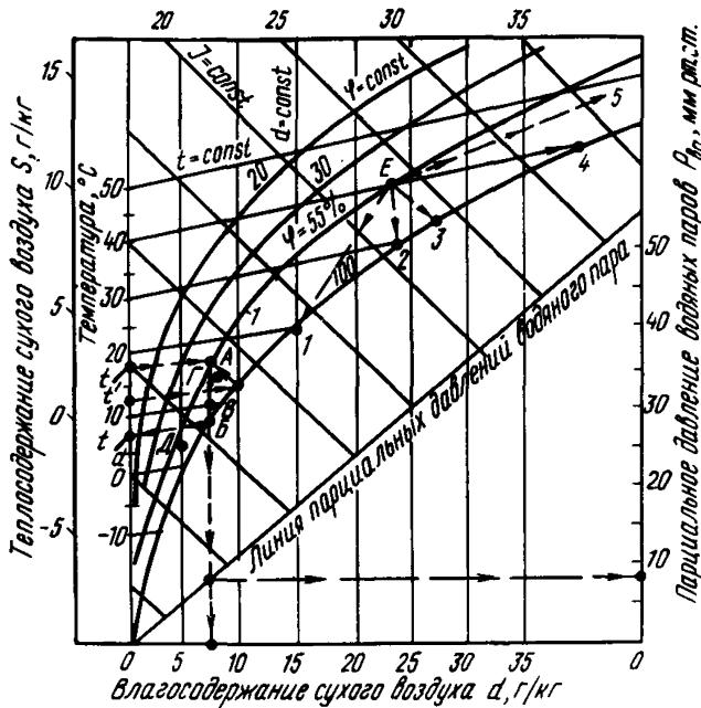
Рис.6. Ключ к  $I - \alpha$  - диаграмме влажного воздуха для давления 760 мм рт.ст.
