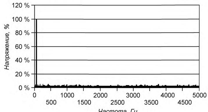
Спектр частот напряжения на выходе преобразователя — инвертора напряжения типа В,  $f_1 = 50$  Гц,  $f_{s \text{ sp.}} = 4,5$  кГц
