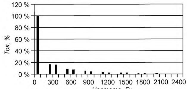
Спектр частот тока на выходе 6-пульсного преобразователя — инвертора тока,  $f_1 = 50$  Гц
