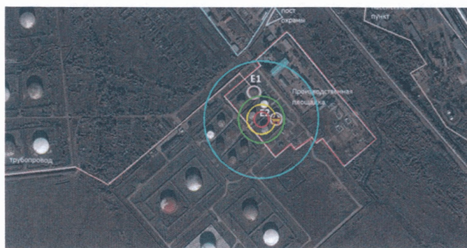
Рис. 5-4. Зоны распространения ударной волны при взрыве ТВС
