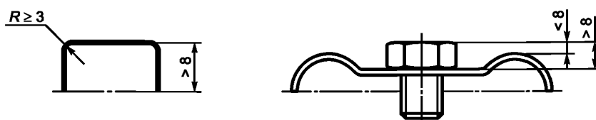
Рисунок 2 — Примеры допустимых выступающих элементов оборудования
