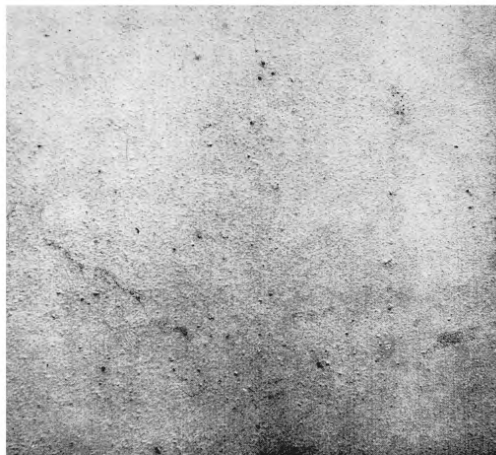
Рисунок 9 — Коррозия металла балл K1 (или Ri 1)
