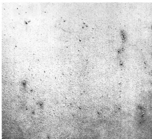
Рисунок 10 — Коррозия металла балл K2 (или Ri 2)
