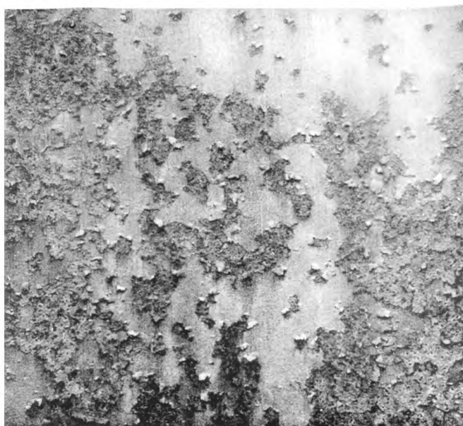
Рисунок 13 — Коррозия металла балл K5 (или Ri 5)
