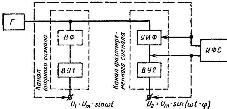
Напряжение от генератора  $\Gamma$  поступает одновременно на устройство измерения угла сдвига фаз  $УИФ$ , в качестве которого обычно используют градуированный круговой фазовращатель, и на вспомогательный фазовращатель  $ВФ$ , служащий для установки нулевого угла сдвига фаз. Для контроля углов сдвига фаз, задаваемых с помощью  $УИФ$ , применяют измеритель угла сдвига фаз  $ИФС$ .
