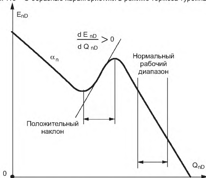
Рисунок 116 – Характеристика насоса с положительным наклоном в ограниченном диапазоне расхода
