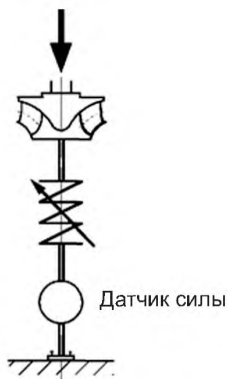
Рисунок 103 – Типичное расположение калибровки для измерения осевого усилия
