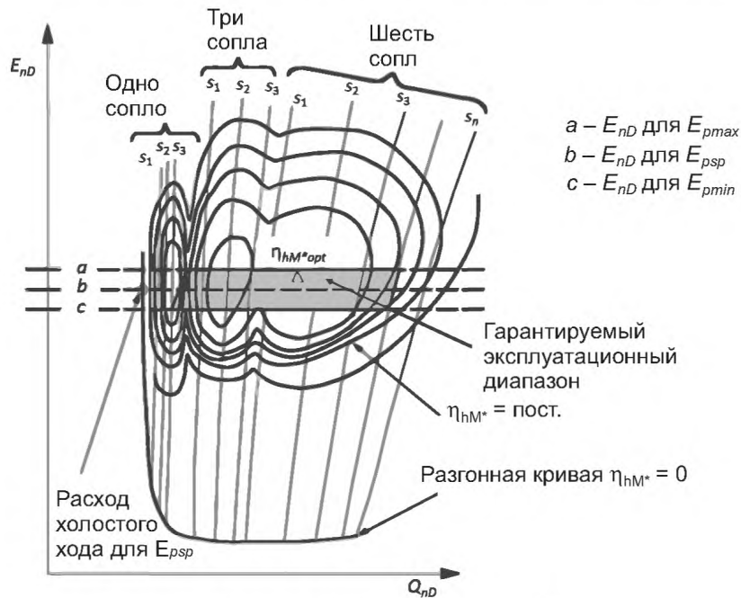
s_1, s_2 \dots s_n – постоянной положение игл Рисунок 60 – Модель ковшовой турбины. Эксплуатационная характеристика (пример для машины с шестью соплами)
