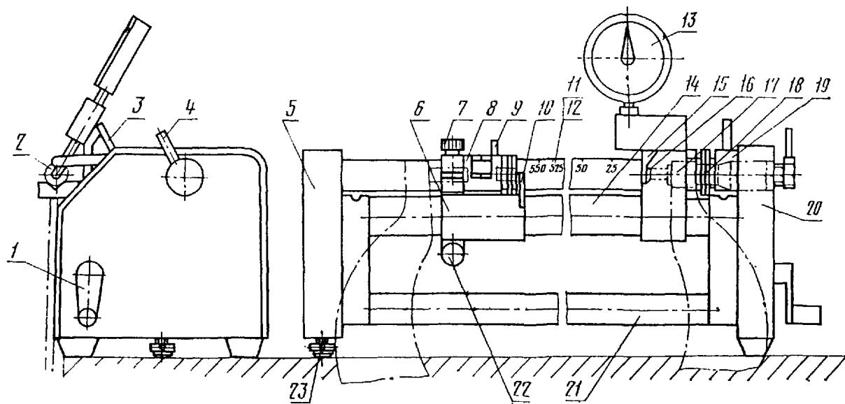
Вращают рукоятку 1 привода и наблюдают по шкале индикатора размах стрелки, то же выполняют при трех других положениях винта микрометра (поворачивая его на четверть оборота), соответствующих показаниям индикатора  $(0,325 \pm 0,005)$  мм;  $(0,450 \pm 0,005)$  мм и  $(0,575 \pm 0,005)$  мм.
