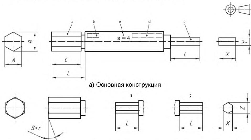
b) Дополнения к конструкции GO калибра или NOT GO калибра для малых размеров
