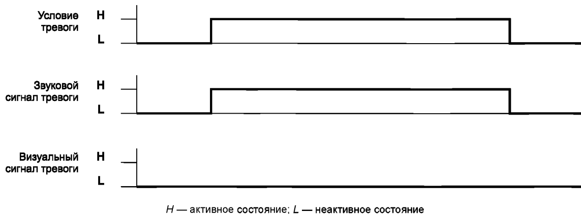
Рисунок ВВ.1 — Нефиксированные сигналы тревоги без переключения тревоги
