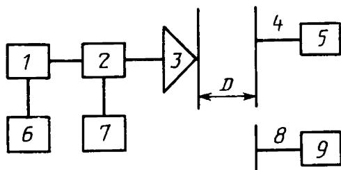
1 — генератор; 2 — индикатор уровня; 3 — излучающая антenna; 4 — образцовая дипольная антenna; 5 — милливольтметр постоянного тока; 6 — частотомер; 8 — поверяемая антenna; 9 — селективный милливольтметр
