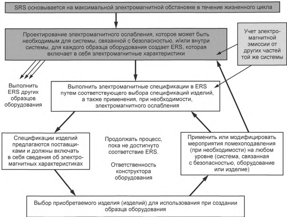
Рисунок D.2 — Процесс достижения электромагнитной спецификации в SRS при использовании коммерчески доступных изделий
