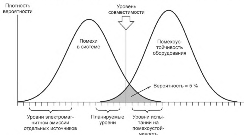
Рисунок Е.1 — Уровни электромагнитной эмиссии/помехоустойчивости на примере уровней электромагнитной эмиссии/помехоустойчивости для одного эмиттера и одного рецептора в зависимости от некоторых независимых переменных (например, амплитуд импульсов в пачке или уровней напряженности поля)
