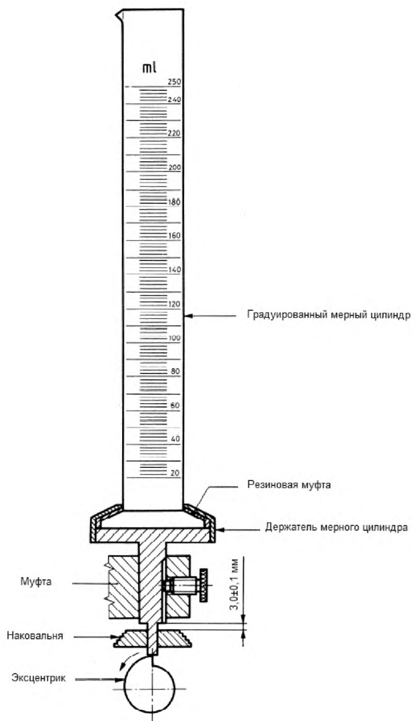
Рисунок 3 — Толчковый измеритель объема для определения насыпной плотности после уплотнения
