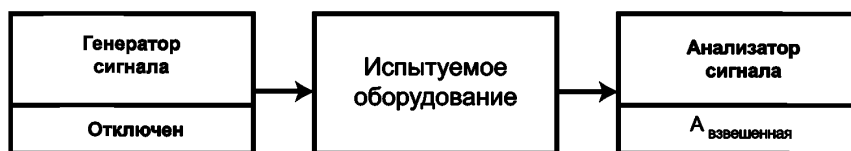
Рисунок 22 — Метод шума в ненагруженном канале
