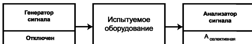
Рисунок 23 — Метод измерения спектра шумов в ненагруженном канале
