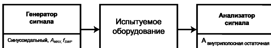
Рисунок 12 — Метод измерения искажения и шума в зависимости от частоты
