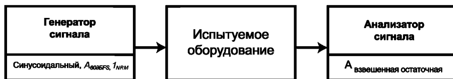
Рисунок 24 — Метод измерения динамического диапазона
