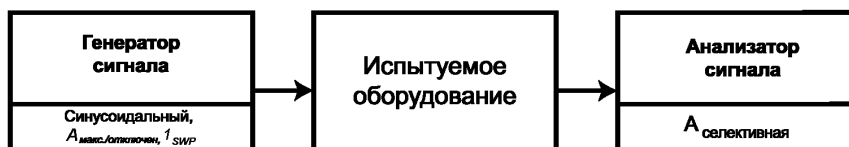
Рисунок 27 — Метод измерения нелинейных перекрестных помех
