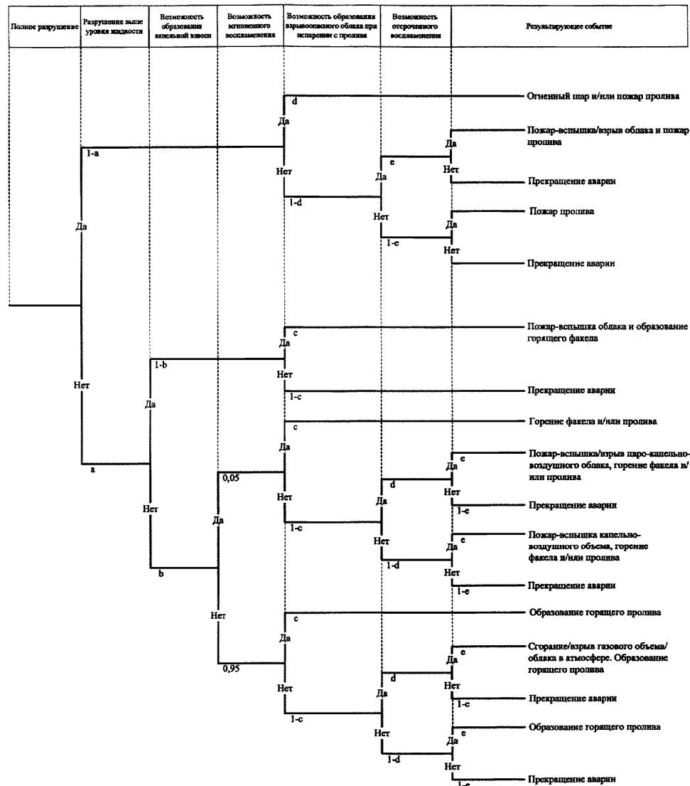
**Рис. 4-2.** Дерево событий при разрушении емкости под давлением
