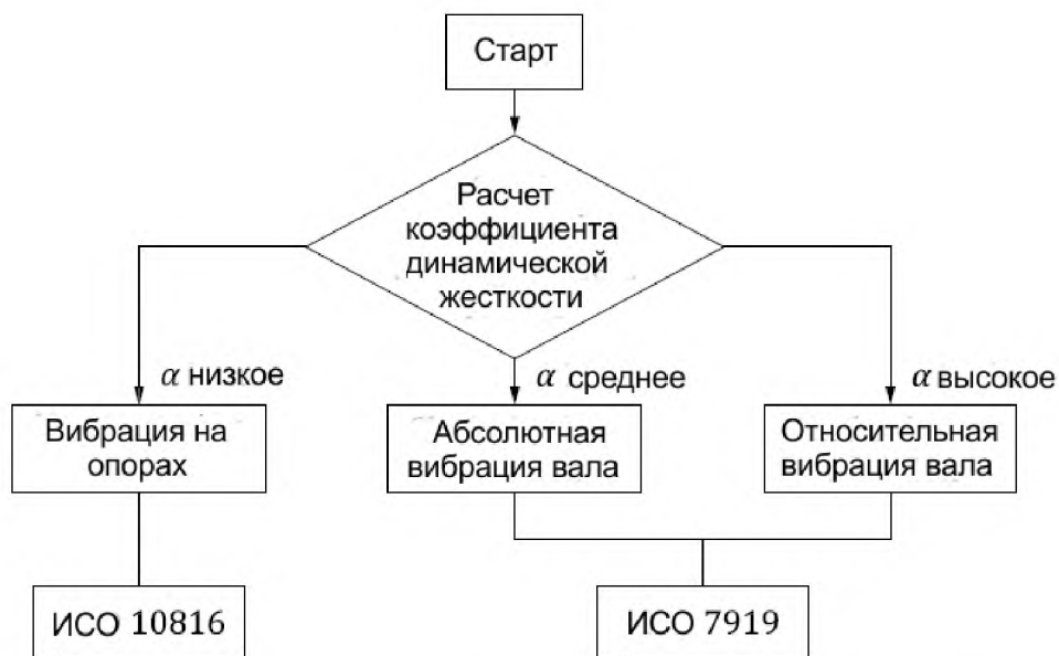
Рисунок 2 — Блок-схема выбора стандарта для измерений вибрации
