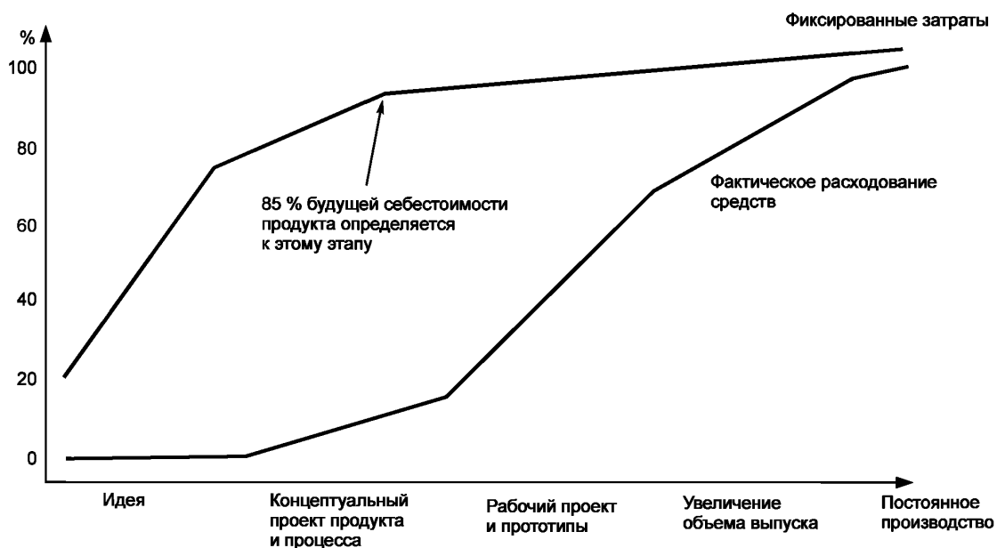
Рисунок 3 — Финансовые обязательства в процессе дизайна, разработки, производства и обслуживания продукции
