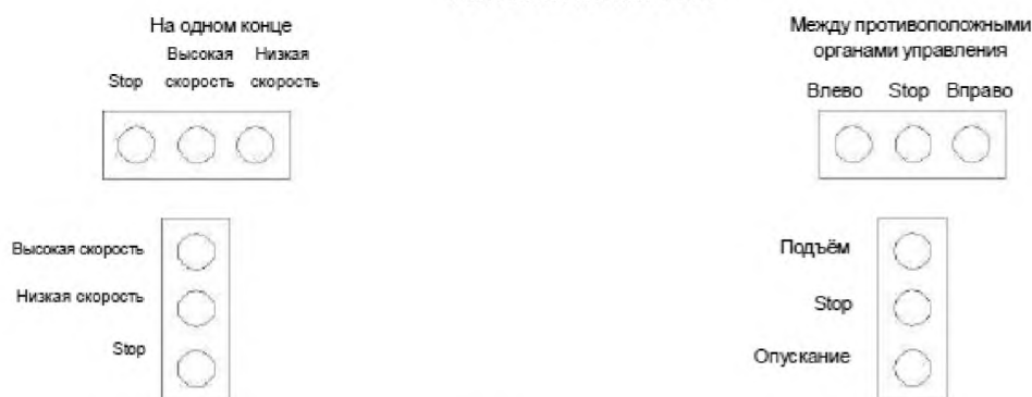
Рисунок 4 — Нажимная кнопка STOP в составе группы органов управления
