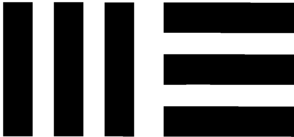
Рисунок 2 — Тест-объект для проверки разрешающей способности
