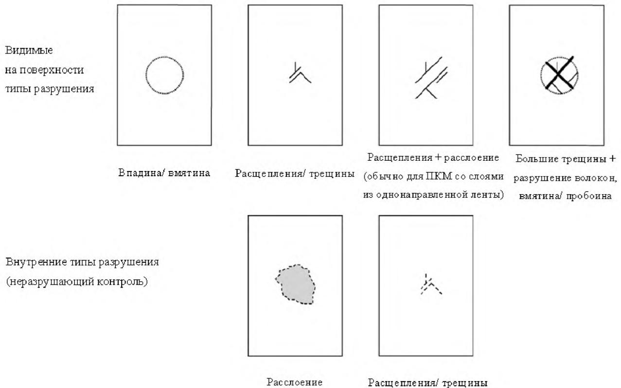
Рисунок 9 — Типовые повреждения в результате удара
