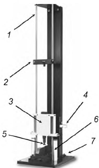
1 — направляющая колонна; 2 — фиксирующее устройство; 3 — траверса; 4 — датчик скорости; 5 — ударник; 6 — блок остановки (ограничитель хода); 7 — основание (базовая панель)
