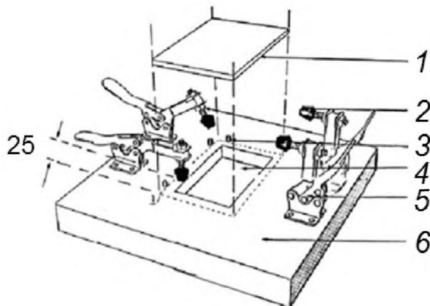
1 — испытательный образец; 2 — зажим; 3 — направляющая шпилька; 4 — полость длиной  $(125 \pm 1)$  мм и шириной  $(75 \pm 1)$  мм; 5 — шарнирно-рычажный зажим; 6 — основание (базовая панель) размерами  $300 \times 300$  мм (не менее)
