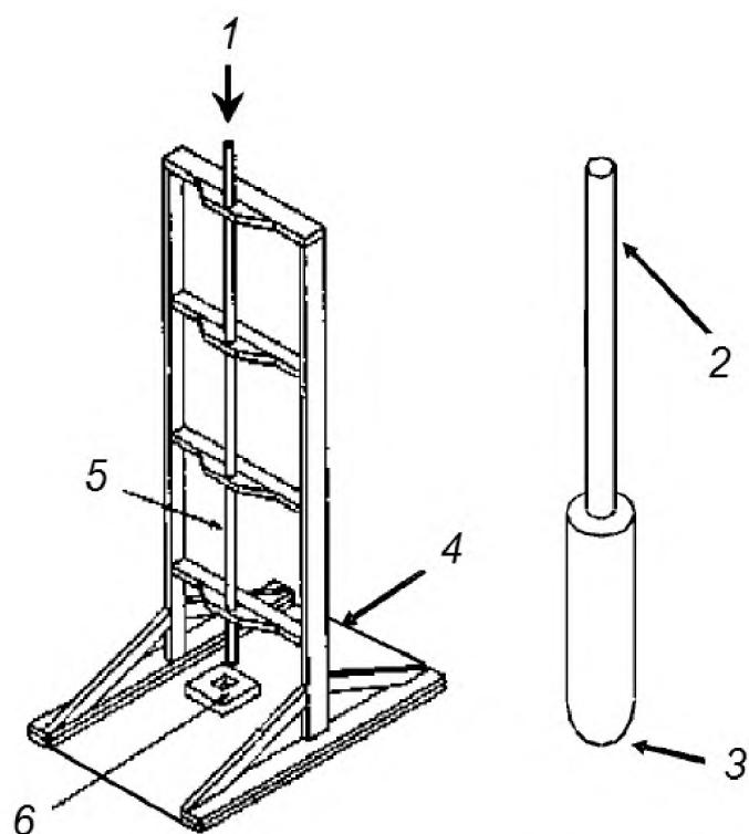
1 — ударник помещен в трубку и установлен на выбранной высоте перед испытанием; 2 — ударник с полусферическим наконечником бойка; 3 — трос (шнур) для установки ударника в цилиндрической трубке на заданной высоте. Массу троса (шнура) следует учитывать при определении полной массы ударника; 4 — жесткое основание; 5 — цилиндрическая трубка; 6 — зажимное приспособление
