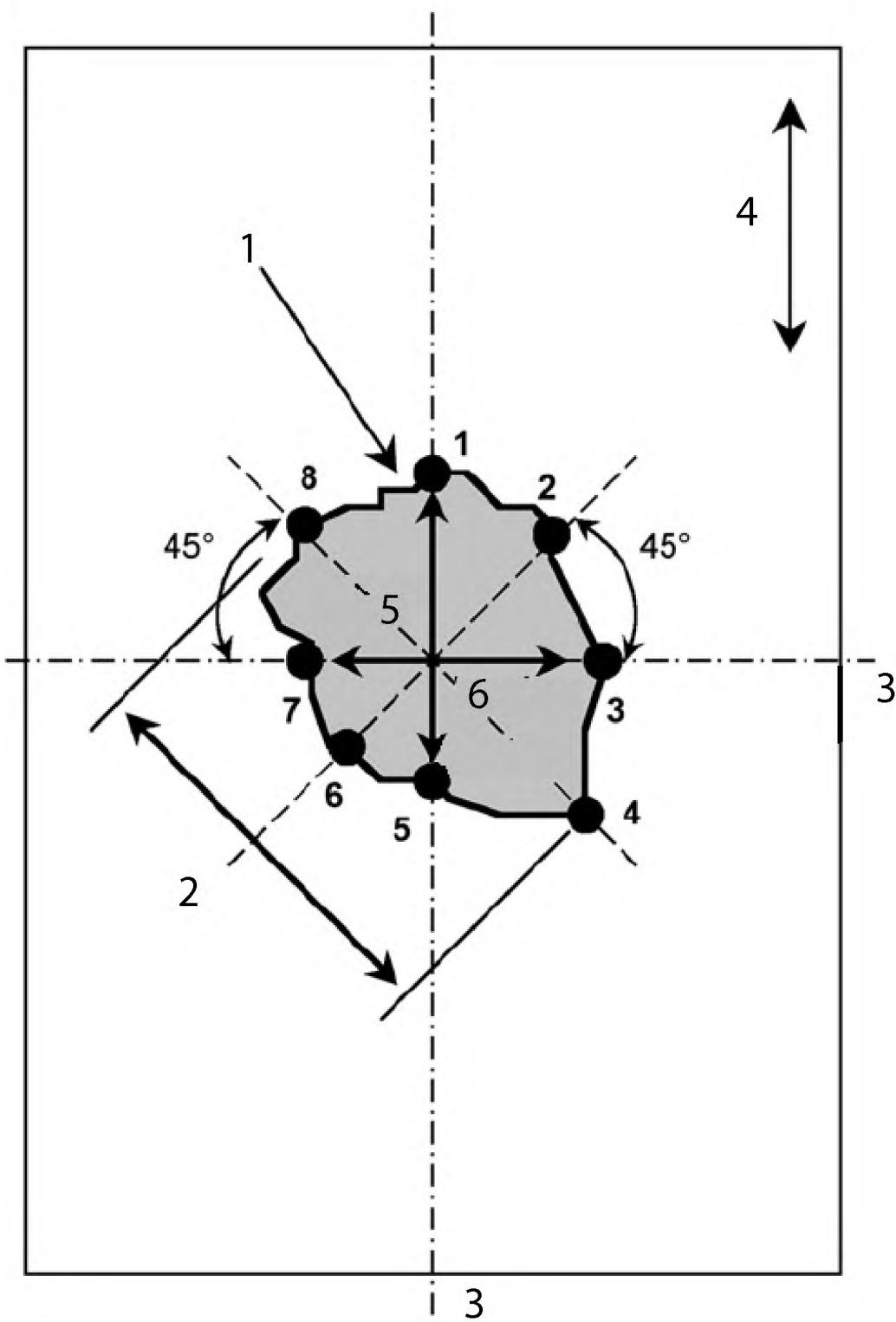
1 — зона разрушения, обнаруженная методом неразрушающего контроля; 2 — максимальный диаметр зоны разрушения;
