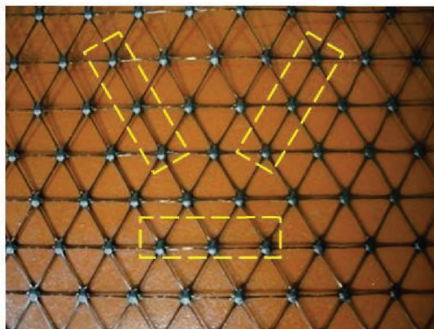
Рисунок А.2 — Схема отбора образцов для испытания на прочность ребра и прочность узла
