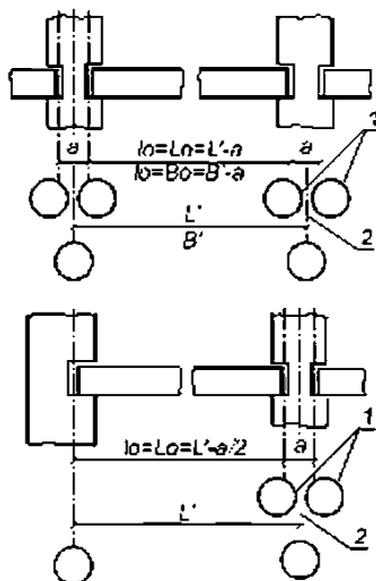
1 – координационные оси здания; 2 – разбивочная ось здания;  $a$  — расстояние между парными координационными осями;  $l_0$  – координационная длина плиты;  $L_0$  и  $B_0$  – расстояние между поперечными и продольными координационными осями здания соответственно;  $L'$  и  $B'$  – расстояние между поперечными и продольными разбивочными осями здания соответственно
