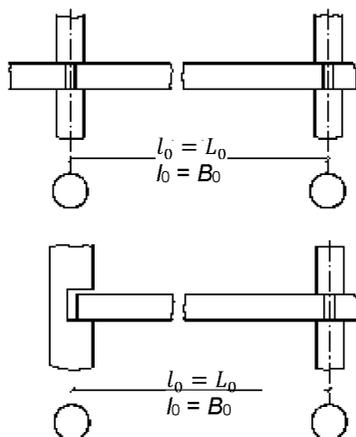
$l_0$  – координационная длина плиты;  $L_0$  и  $B_0$  – расстояние между поперечными и продольными координационными осями здания соответственно
