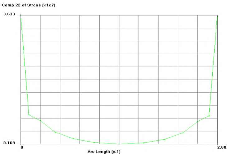
Рисунок 55–Распределение нормальных напряжений в бетоне плиты на горизонтальных площадках в окрестности стального штыря
