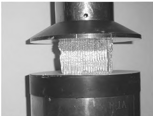
Рисунок 2 — Сведение нагрузочных плит вокруг сжимаемого образца
