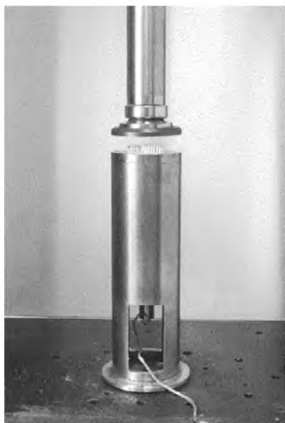
Рисунок 1 — Плита пресса с датчиком и регулировкой стержня
