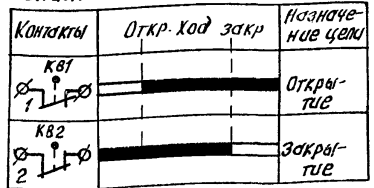
Диаграмма замыкания контактов конечных выключателей исполнительного механизма УИМ
