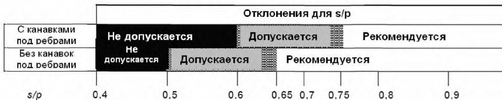
Рисунок 9 — Зависимость межреберного расстояния от вылета ребра( s/p )
