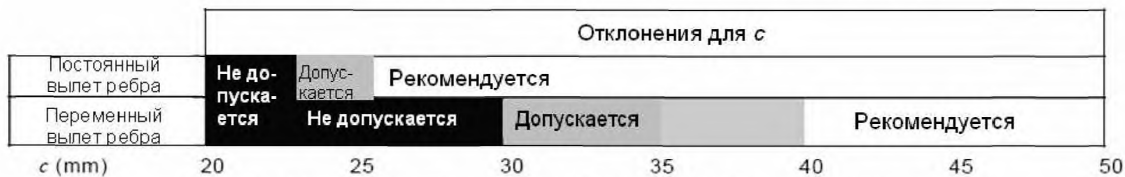
Рисунок 11 — Рекомендации по выбору межреберного расстояния
