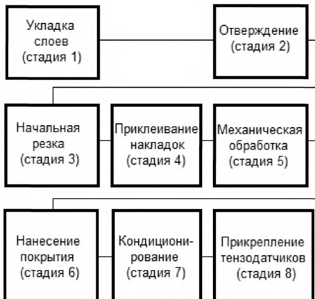
Рисунок 1 — Процесс изготовления образцов для испытания
