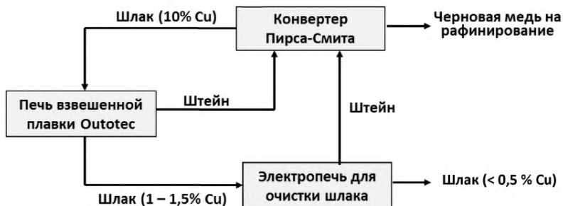
Рисунок 2.12 — Переработка медного шлака в электродуговой печи
