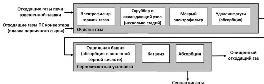
Рисунок Б.27 — Типичная схема газоочистки для сернокислотной установки
