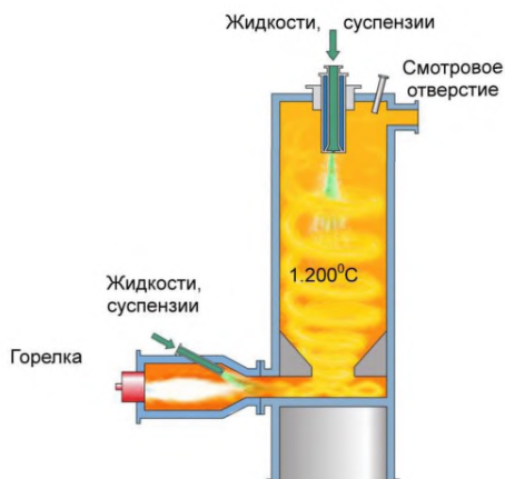
Рисунок 5.19 — Пример конструкции и принципа работы оборудования для высокотурбулентного сжигания отходов и дожигания пирогазов (П23) (см. таблицу 5.5)
