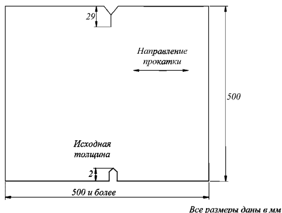
Рис. 3.20.6.4.1 Форма и размер испытываемого образца
