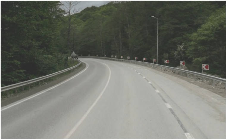
Рисунок 2 – Металлическое барьерное одностороннее дорожное ограждение
